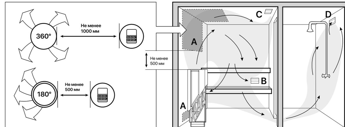
A. Размещение приточного вентиляционного отверстия. Если используется механическая вентиляция, поместите вентиляционное отверстие над каменкой. Если вентиляция естественная, поместите вентиляционное отверстие под или рядом с каменкой. Диаметр трубы для притока воздуха должен быть 50-100 мм. TRT-E: Вентиляционное окно не должно охлаждать температурный датчик (см. инструкции по установке температурного датчика в руководстве по установке пульта управления)!
