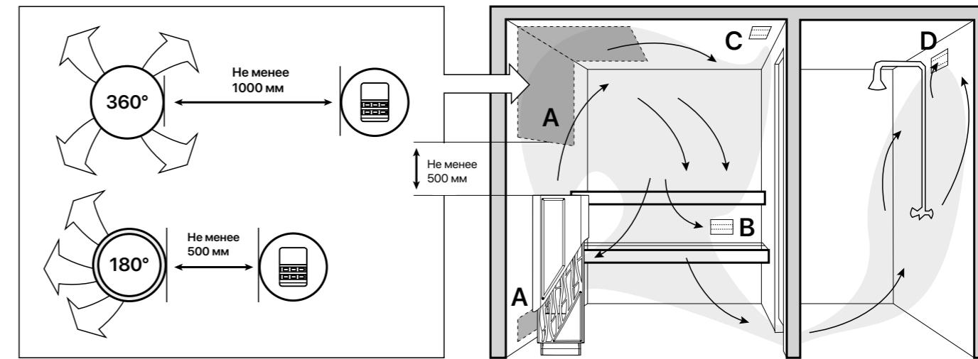
A. Размещение приточного вентиляционного отверстия. Если используется механическая вентиляция, поместите вентиляционное отверстие над каменкой. Если вентиляция естественная, поместите вентиляционное отверстие под или рядом с каменкой. Диаметр трубы для притока воздуха должен быть 50-100 мм. TTR-E: Вентиляционное окно не должно охлаждать температурный датчик (см. инструкции по установке температурного датчика в руководстве по установке пульта управления)!
